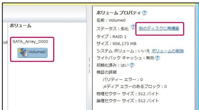
9. 交換したストレージを選択し、「再構築」をクリックします。
